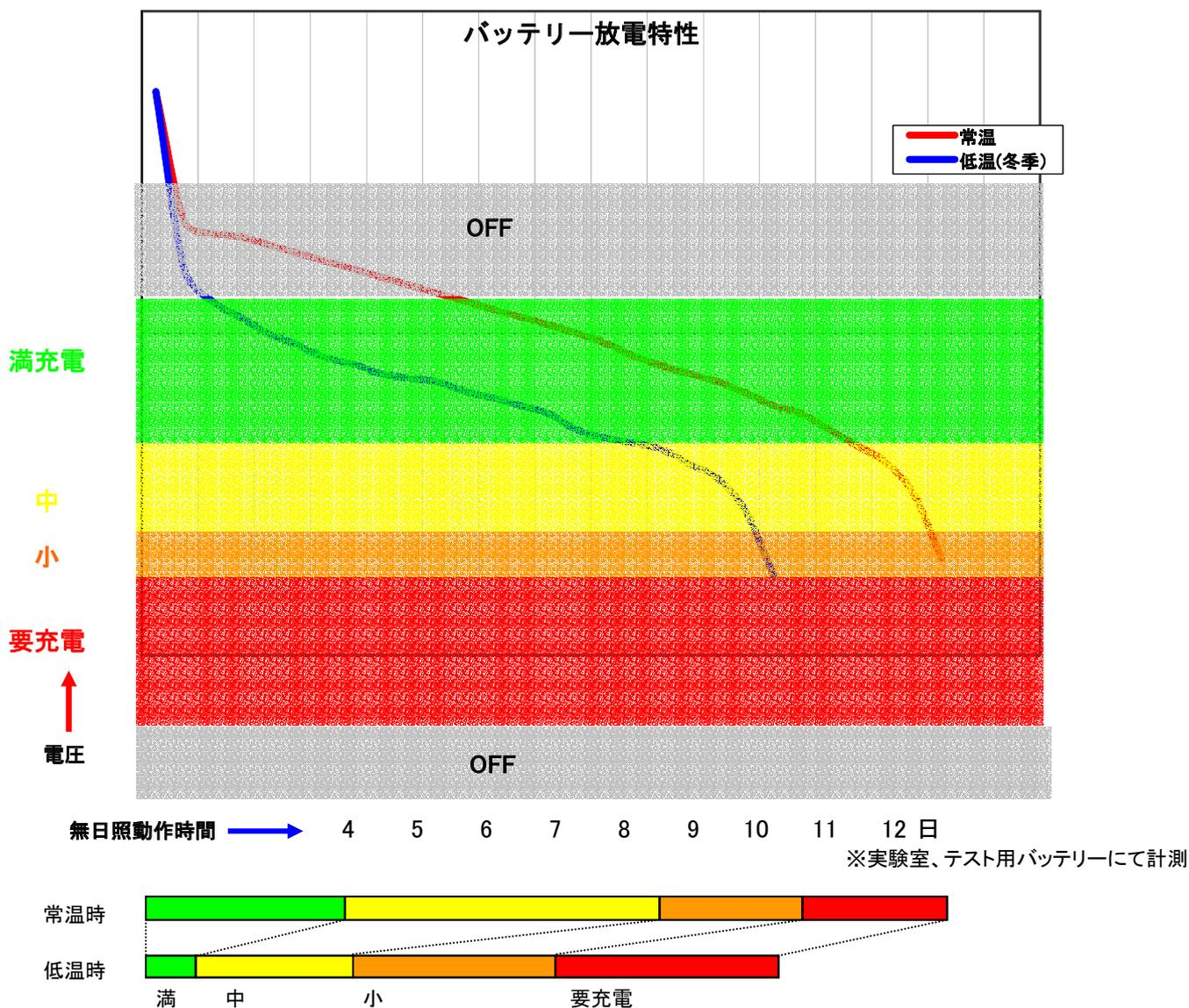
※ GPSハイテク信号機は、ソーラーパネルからの充電がなくとも、7日以上動作するように設計されています。常温時と冬季低温時では、バッテリーの特性から残量表示が、低いほうへ移行し、小表示と要充電表示の範囲が広がります。
